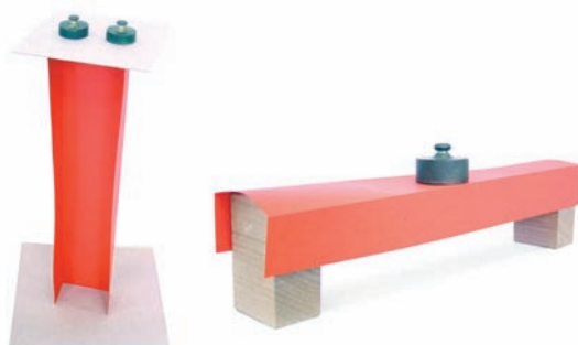
Preskus trdnosti U profila na tlak in upogib
