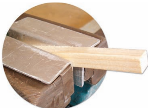
Čeljusti iz mehke pločvine ali deščice
