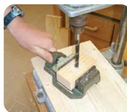
Vpetje s strojnim primežem pri vrtanju
