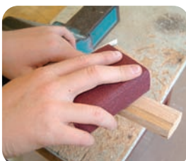
Zmatost 80: srednje grob papir - za vse vrste brušenja
