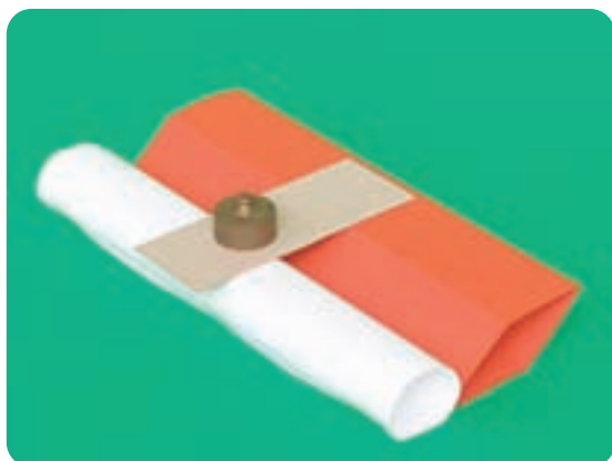
Če kvadratni profil na krajišču ni vpet, prenese le vzdolžno obremenitev.
