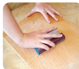
Zmatost 240: zelo fin papir - za vmesno brušenje pri lakiranju
