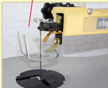
Delovni del z omejevalcem gibanja obdelovanca in žagica
