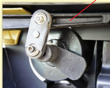
Prenosni sklop gibanja z izsrednikom, drogom in jarmom za vpetje žagice
